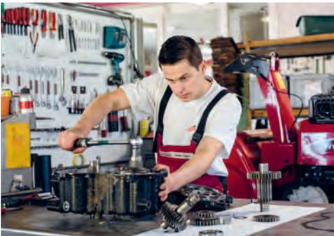
Una trasmissione viene smontata.
