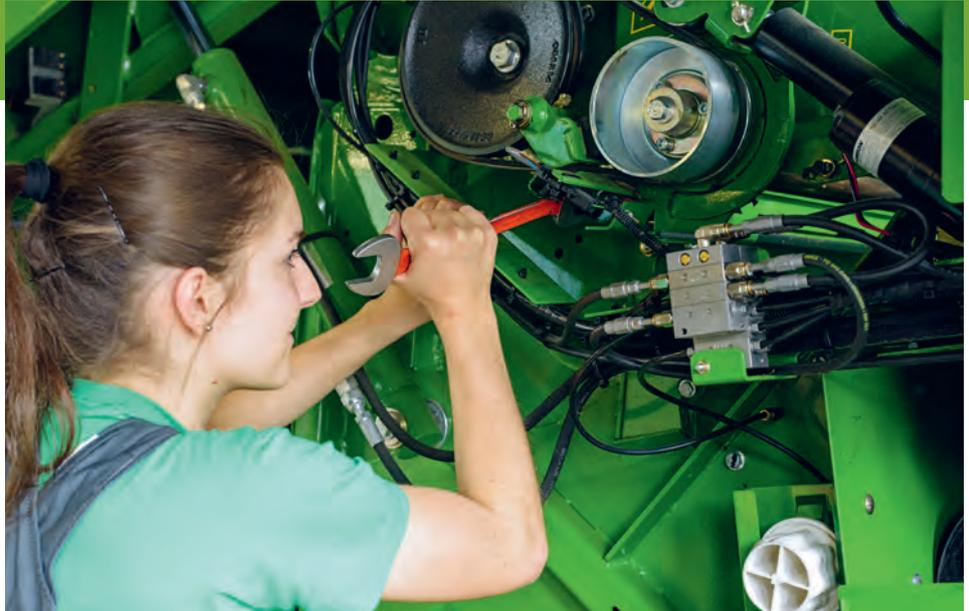
La tensione della cinghia della trasmissione della pressatrice di balle viene impostata.
