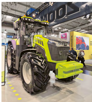
Le tracteur hybride DV3504 du constructeur chinois Zoomlion promet une puissance système pouvant atteindre 500 ch.
